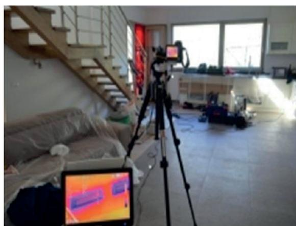
**Prove strumentali termoflussimetriche in situ eseguite da tecnici accreditati. Impostazione della prova: sequenza in 72 ore di 1252 misure in accordo con la norma ISO-9869**
