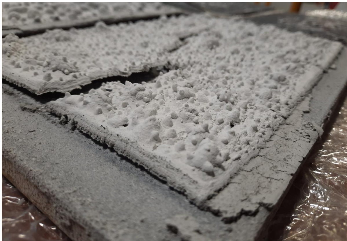
Vzorek 2a (tl. plechu 15 mm, tl. ochranné vrstvy 1 456 µm) – OS po zkoušce
