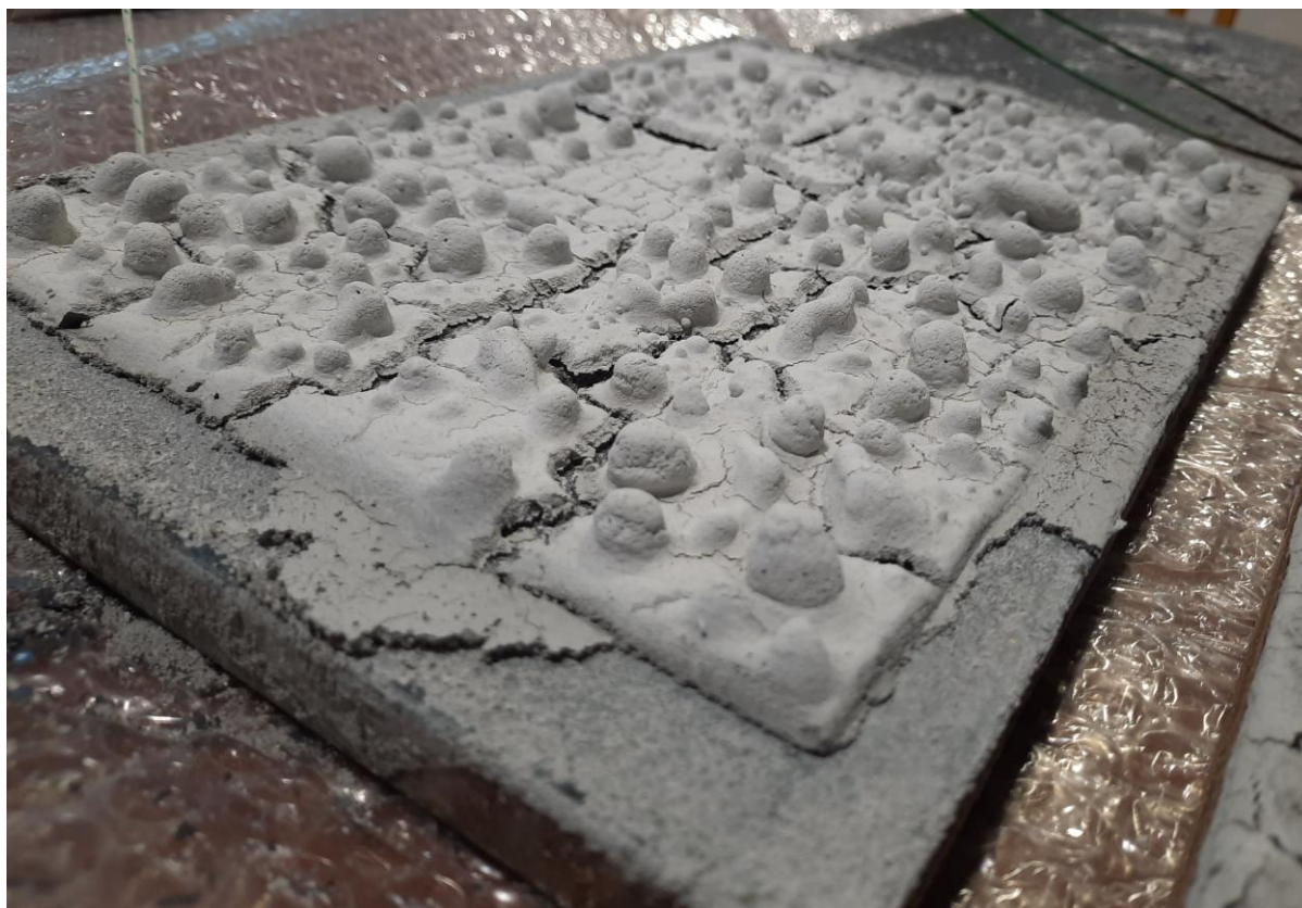
Vzorek 2a (tl. plechu 15 mm, tl. ochranné vrstvy 1 128 µm) – OS po zkoušce
