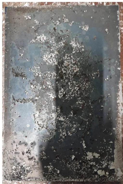
Vzorek 1b (tl. plechu 5 mm, tl. ochranné vrstvy 1 396 \mu\text{m} )
