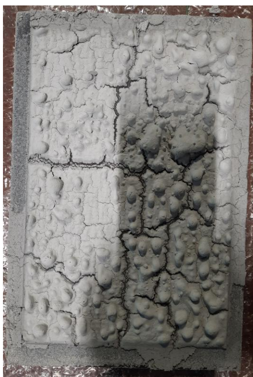
Vzorek 2a (tl. plechu 15 mm, tl. ochranné vrstvy 1 128 \mu\text{m} )
