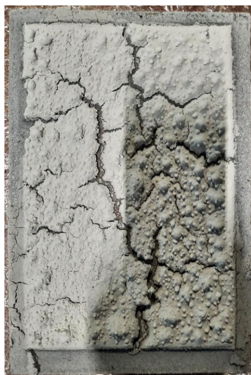
Vzorek 2b (tl. plechu 15 mm, tl. ochranné vrstvy 1 456 \mu\text{m} )
