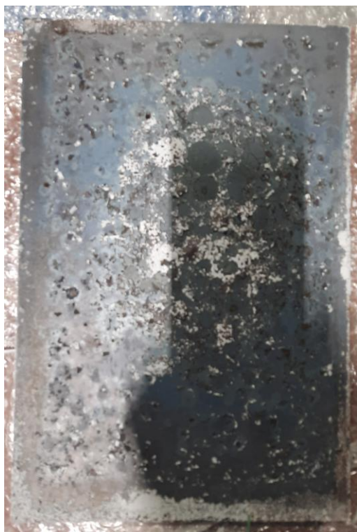
Vzorek 1a (tl. plechu 5 mm, tl. ochranné vrstvy 1 210 \mu\text{m} )
