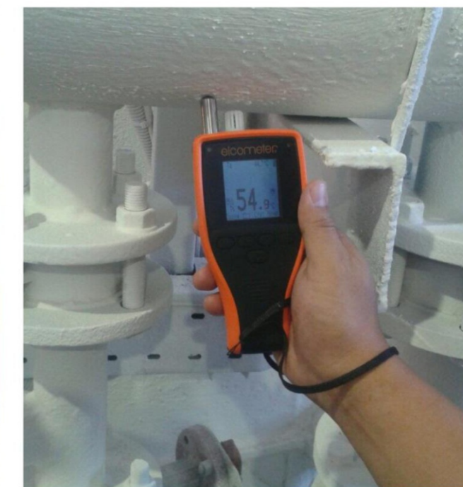
Точные замеры ЖКТМ можно произвести Elcometer® 319 или тактильным тестом
