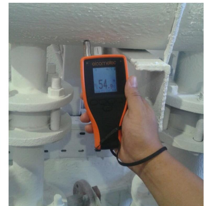
Точные хамеры ЖКТМ можно произвести Elcometer® 319 или тактильным тестом
