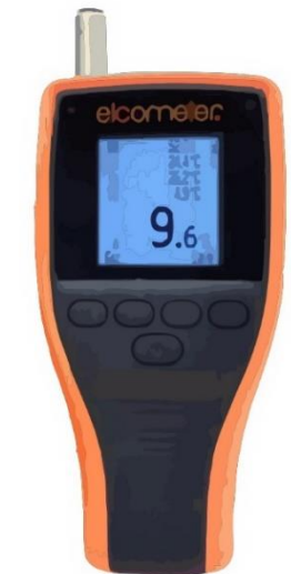
Точные хамеры ЖКТМ можно произвести Elcometer® 319 или тактильным тестом
