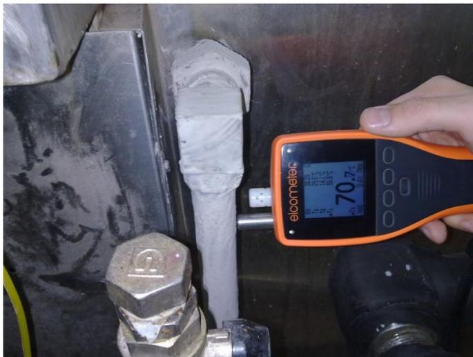
Данные тепловизора Testo радикально отличаются от показаний предыдущего прибора и превышают температуру на неизолированном участке трубопровода и составляют 225 °С. Это происходит из-за наличия в теплоизоляции керамической вакуумированной микросферы, которая искажает длину волны тепловизора.
