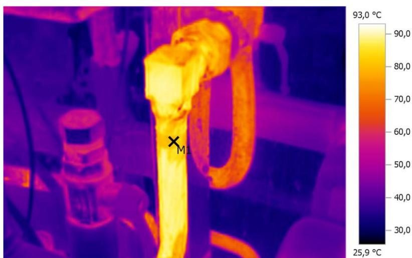
Следующие замеры производились после высыхания последнего слоя материала, при толщине жидкой керамической теплоизоляции Броня в 2 мм.
