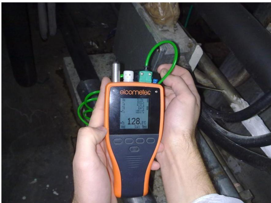
Температура на поверхности теплоизоляции «Броня» по данным Elcometra 319 составила 40<sup>0</sup>С.
