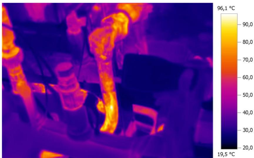
Однако рука спокойно выдерживает прикосновение с теплоизоляцией более 30 секунд, что соответствует 40-50<sup>0</sup>С.
