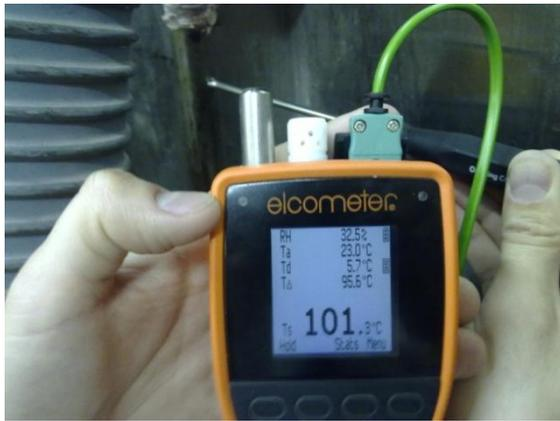
По данным Elcometer 319 температура на поверхности теплоизоляции первого слоя составляла 70 °С.
